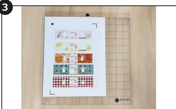
3 印刷した用紙をカッティング台紙に貼り、カメオにセットします。スキャナーがトンボマークを読み取り、デザインの周りをカットしていきます。
